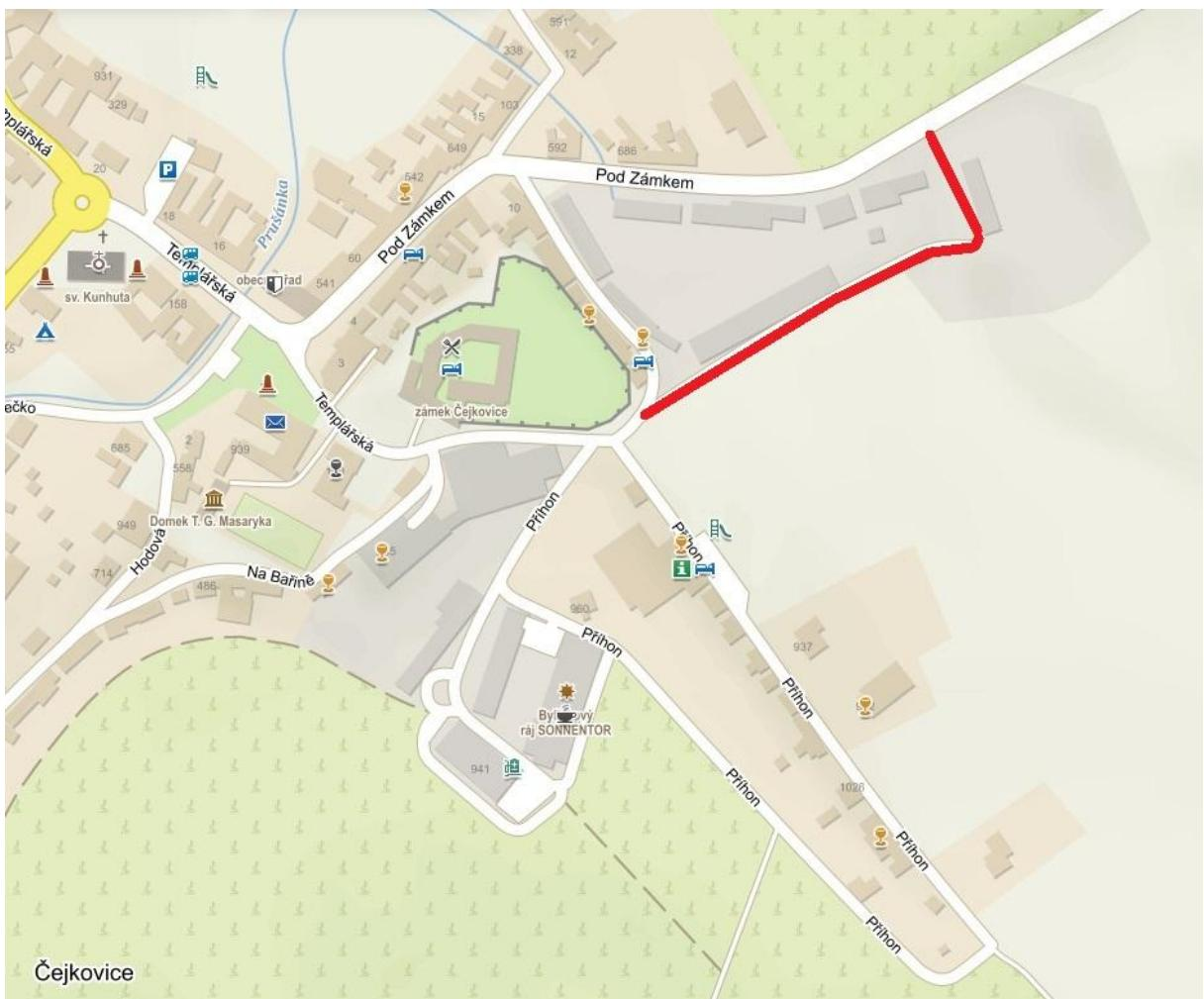
Varianta 2A je návrh nového dopravního napojení na silnici III/4259 vedoucího severním okrajem přestavbové plochy P6 až na západní okraj přestavbové plochy P5 odkud je vedena severním směrem po hranici plochy východně podél stávajícího objektu (haly) až k napojení na stávající silnici třetí třídy. Komunikace je ve studii navržena jako účelová jednopruhová obousměrně pojízděná s výhybnami.
