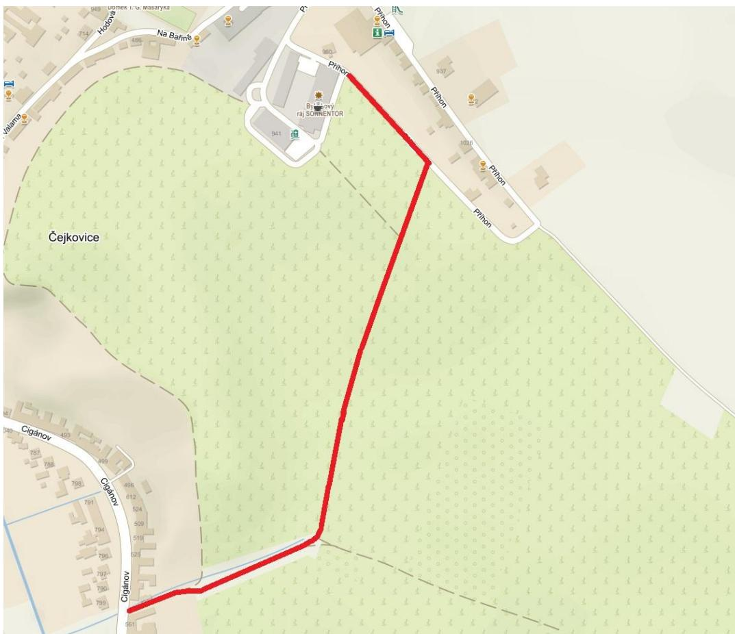
Varianta 3 využívá trasu stávající účelové komunikace mezi vinicemi vedoucí od návrhové plochy Z28 jižním směrem k silnici III/42222 ulici Cigánov. Komunikace je navržena jako jednopruhová, obousměrně pojízděná s výhybnami. V místě dopravního napojení na silnici III/42222 bude nutno upravit stávající propustek pod samicí prodloužením zatrubnění z důvodu rozšíření stávajícího dopravního napojení na normové hodnoty.
