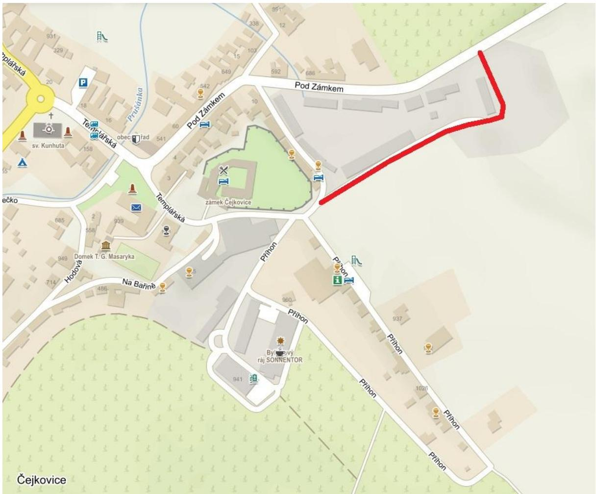
Varianta 2B je svým vedením téměř shodná s variantou 2A, přičemž dopravní napojení na silnici III/4259 je navrženo až za objektem haly p.č.1187. Opět se jedná o jednopruhovou úcelovou komunikaci obousměrně pojízděnou.
